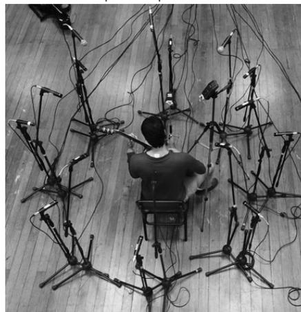
Fig. 1 Arreglo semiesférico de micrófonos para medición de directividad de la guitarra acústica
