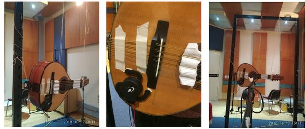
Fig. 14 Montaje medición Respuesta al impulso de Bandola Paredes y Pimentel<sup>14</sup>
